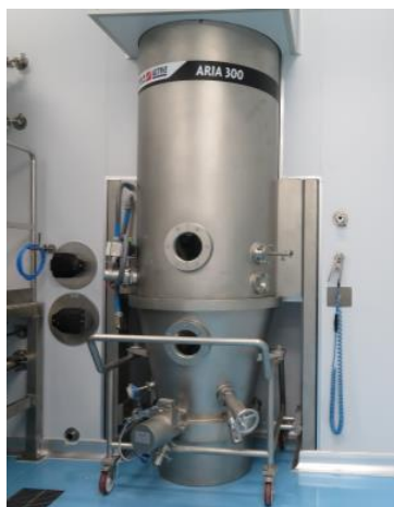
攪拌造粒機 : ROTO MIX 300 (IMA社) (左) 流動層造粒乾燥機 : ARA300 (IMA社) (右)
