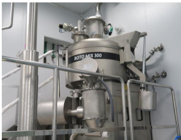
攪拌造粒機 : ROTO MIX 300 (IMA社) (左) 流動層造粒乾燥機 : ARA300 (IMA社) (右)
